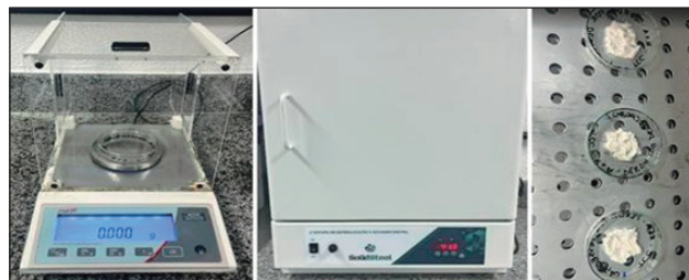
Figura 3 - Equipamentos utilizados para realização do ensaio de perda de água por dessecação.
