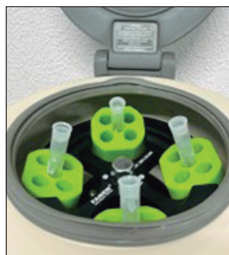
Figura 4 - Posição dos tubos Falcon® na centrífuga.
