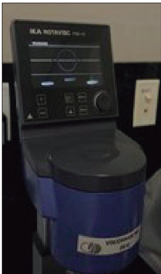
Figura 2 - Viscosímetro ROTAVISC - Ika mevi.
